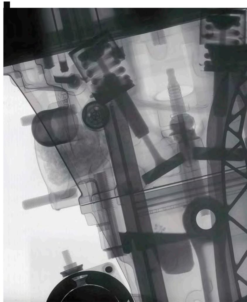
Das Innere eines Motors: Neutronen können massive Gegenstände durchdringen, sogar die Ventile werden sichtbar. Röntgenstrahlung würde nur einen schwarzen Klotz zeigen
